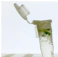
写真2. 減圧中、マイクロチューブの中に泡が見える様子
