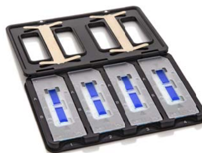
図1: Cell Chip アダプター。4 チップの同時測定が可能。
