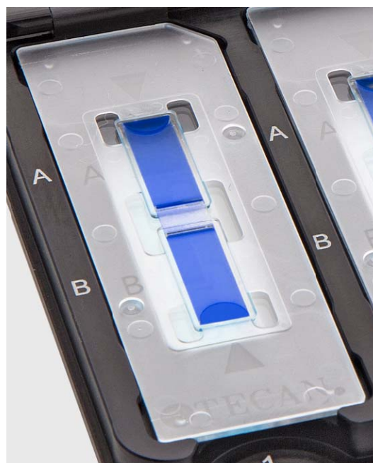
図 1: Tecan Cell Chip。サンプルチャンバー 2 か所付き。
