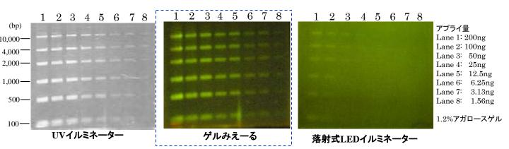
\*ゲルみえーると落射型LEDトランスイルミネーターでのバンド撮影は、暗室で市販のデジタルカメラを使用して撮影しました。また、UVトランスイルミネーターは暗箱付きの撮影装置を使用しました。
