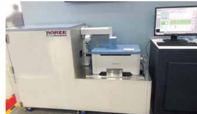
CQ1とスタッカシステムの連携例 構成機器: 専用スタッカ (培養機能を追加可、標準付属のカバーにより暗室対応可)
