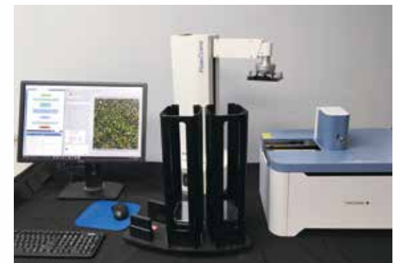
CQ1とスタッカシステムの連携例 構成機器：スタッカ、ロボットハンドラ
