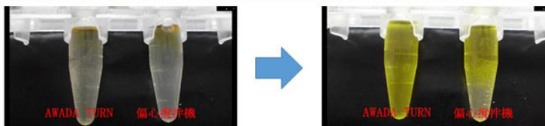
30% (w/w) PEG溶液と黄色色素を攪拌しました。偏心攪拌機では粘度が高く均一に攪拌できていませんが、AWADA TURNでは全体に満遍なく攪拌ができています。従来の偏心攪拌機では攪拌できなかった高粘度溶液の攪拌が可能となります。
