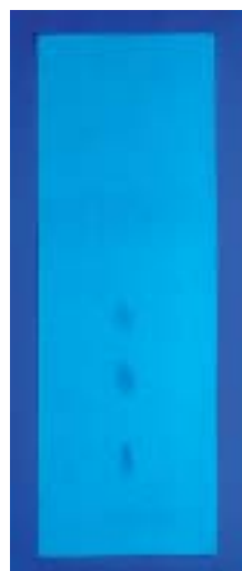
クロマトシートの紫外線（254nm）による検出例
