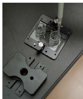
マイクロ流路チップにシース液、試料液を充填。
