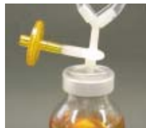
カラーキャップをはずした後、ゴム部分に針を刺し、使用する。
