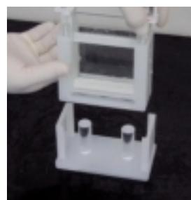
泳動後は、バッファーを取り除き、リムーバーでゲルプレートを押し出します。
