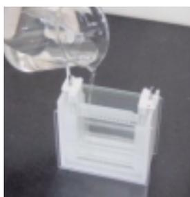
V・セルホルダー(陰極バッファー槽)に泳動バッファーを入れます。
