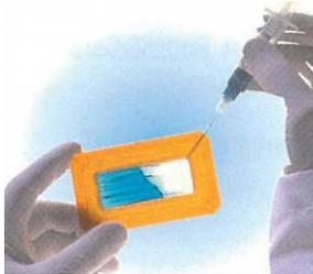
1、手袋をはめ、ガasket上のガイド孔の一つに専用シリンジ(別売り)を突き刺し、サンプルをカセット内に注入する。シリンジがカセット孔に挿入されている状態で内筒を引き、カセット内の空気を取り除く。その後シリンジを引き抜く。
