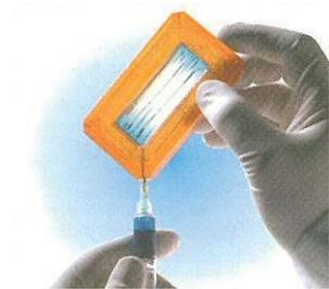
3、カセットのサンプルを入れたガイド孔とは異なる方のガイド孔にシリンジを突き刺し、膜が破れないように注意しながら空気を注入後、サンプルを採取する。
