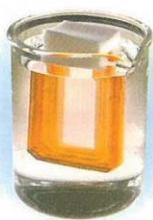
2、カセットをプイ(別売り)にセットし、透析を行う。(12~30m/用はプイが内蔵されているため、プイを装着せずに透析できます。)
