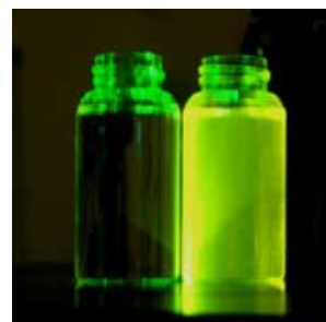
Spy-LHP(左)及びその酸化体(右)の蛍光変化写真
