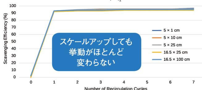
パラジウム触媒を用いた鈴木-宮浦カップリング反応後の混合物からのパラジウム触媒の除去効率を確認しました。それぞれのE-PAK カートリッジサイズを変更することにより、合成スケールを変えても性能 (捕捉率%)、反応速度、相対容量の挙動は非常に類似している結果となりました。
