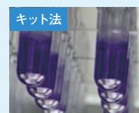
従来のマイクロプレート底面に形成させる方法では難しかった均一なバイオフィルムをピンプレートに形成させ測定することで、ばらつきの少ないデータを精度よく測定できます。バイオフィルム形成条件の検討にご利用できます。
