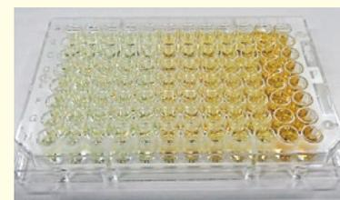
ピンプレートに形成させたバイオフィルム中の微生物生存率をWST法によって測定できます。バイオフィルム内微生物に対する抗菌剤の検討などに利用できます。
