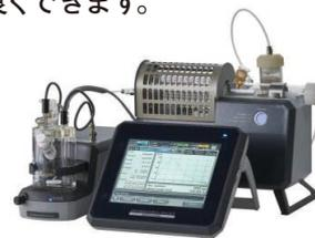
※写真は電量滴定法と気化法の組合せです。気化装置を電量滴定法側に接続すれば固体試料の測定も可能です。
