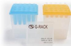
ETFE樹脂、気化排気口を導入することにより、耐薬品性を高めました。酸、有機溶剤、アルカリ等のサンプルが、すべて計量可能なモデルです。専用アダプターを装着すればガラスチップも使用可能となり、従来のプラスチックチップでは困難であった有機溶媒の分注も可能となります。
