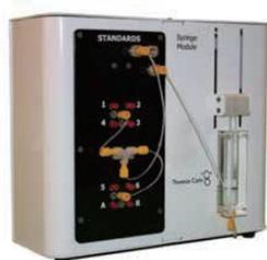
標準試薬やスパイクを添加することを目的として、DEENAシリーズ専用開発されたシリンジモジュールです。最大6種類の試薬を搭載することができます。
