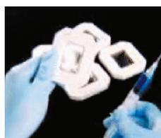
⑥ カセットの透析済サンプルをシリンジで採取する。
