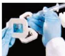
⑤ 透析液からカセットを取り出し、サンプルを注入していない方のシリコンガスケットにシリンジを突きさし、カセット腔にシリンジで注意深く空気を入れる。
