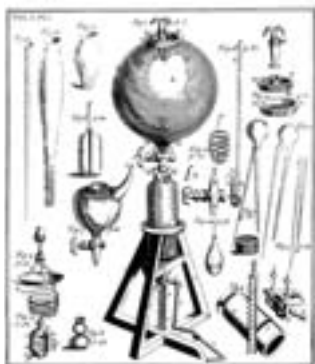
図3. ボイルの最初の真空ポンプ。ガラス製の受器の容量は約28.5リットル、真鍮製の円筒型ポンプの長さは35.6センチであった。
