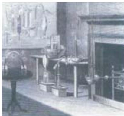
図6. プリーストリの実験室。暖炉で加熱した固形物に銃身を挿入し、抽出した気体を、水銀を満たした盆に倒置した円筒に導く。左側のU字管で気体中の放電火花の実験をした。
