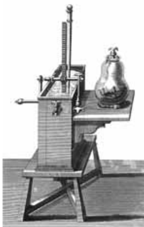
図7. ボイルの空気ポンプ2号機(『ボイル著作集』、第三巻)。ピストンの革を濡らせておくためポンプは水中に沈めてある。(『ボイル著作集』、第三巻)。
