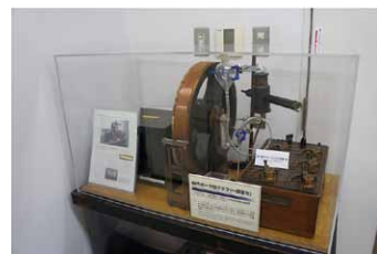
図3. 志方がプラハから持ち帰ったポーラログラフ装置(一部復元、京都大学農学研究科応用生命科学専攻生体機能化学分野所蔵)
