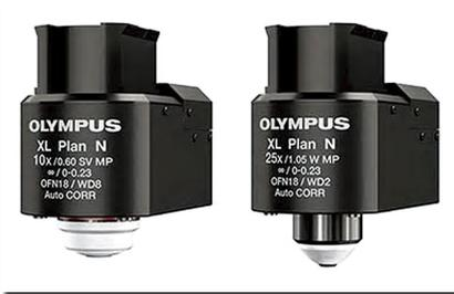
図9. TruResolution システム用対物レンズ補正環を電動で駆動し、画像解析を行うことで、補正環の最適な位置を自動で判別する。また、観察する深さの変化に連動して自動で補正環を最適な位置に調整する。
