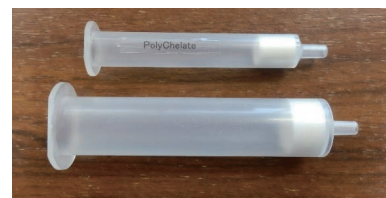
写真 12mL空リザーバに再充填した固相カラム
