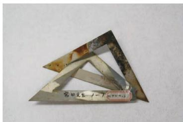
写真4. 多孔性（重なっていた部分のみ）の滅失した三角定規
