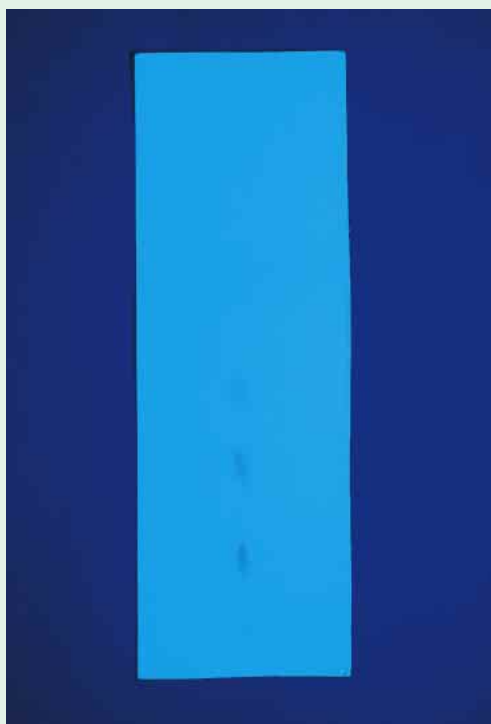
クロマトシートの紫外線(254nm)による検出例 サンプル: ブルシン、オキシプロピルテオフィリン、カフェイン 展開溶媒: クロロホルム9+メタノール1
