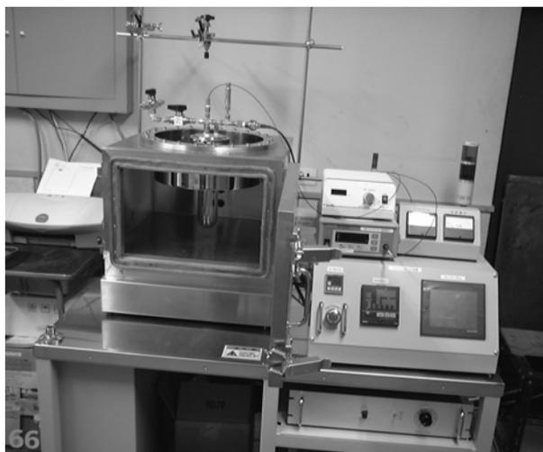
図5 MFI ゼオライト製膜に用いたマイクロ波加熱装置
