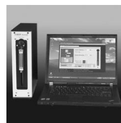
シリンジポンプ単独でも構築 可能。フロー合成用のポンプ としてお使いいただけます。
