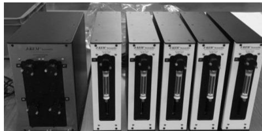
自動で合成を行う際の最小構成例。シリンジポンプ5台とバルブモジュールを組み合わせて構成します。
