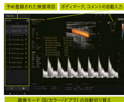
予め登録された検査項目 ボディマーク、コメントの自動入力
